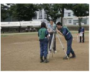
ものづくりコンテスト測量部門「トータルステーションを用いた閉合トラバース測量とその計算」 トータルステーションを用いた閉合トラバース測量とその計算について、作業時間と正確さを競う。1校 1チーム3名とし、外業と内業をそれぞれ制限時間内行う。5角形で総測線長は140m位とする。外業 は3人が順に各点を測量して行う。内業は1人ずつそれぞれが計算をして計算書を完成させる。外業と、 3人の内業の合計の得点で競う。
